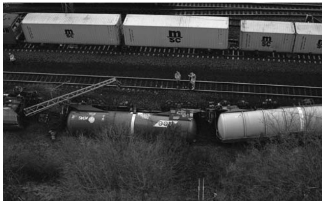
Die umgestürzten Kesselwagen
