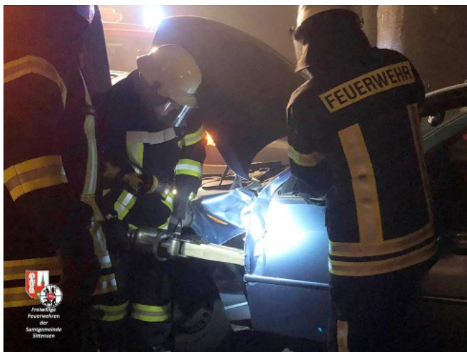
Bei dem verunfalltem Pkw in Ippensen muss mit dem hydraulischen Spreizer die Fahrtür heraus getrennt werden.
